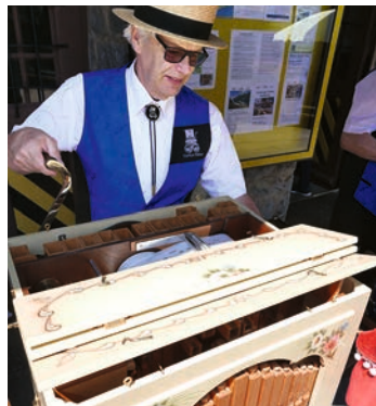
Mechanische Drehorgeln werden noch heute mit Lochbändern / -karten angetrieben und steuern so die verschiedenen Pfeifen an.
